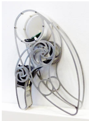
Abbildung 1: Der Roboter SEMNI. Dieser Roboter wurde am Forschungslabor Neurorobotik entwickelt und vereinfacht die Entwicklung von Algorithmen, indem der Bewegungsraum auf eine Ebene reduziert ist.
