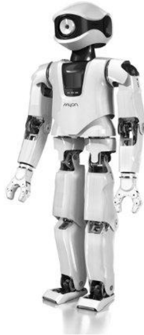
Abbildung 2: Der humanoide Roboter Myon. Dieser Roboter ist modular aufgebaut und kann aufgrund der verteilten Rechenleistung und Energieversorgung während seiner Laufzeit montiert und demontiert werden [34].
